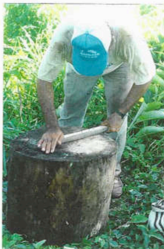
Photo N° 51 : José "Taco" en train de tracer sur le fût de la tambora à l'aide de la vitola .
