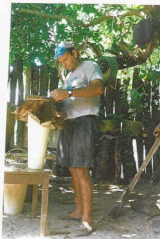
Photo N° 54 : José "Taco" installe le cercle intérieur et rase la peau.
